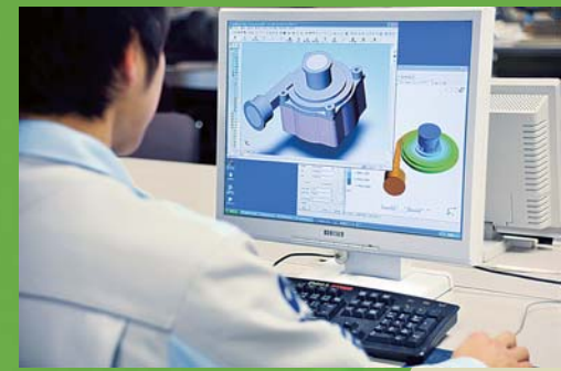
利用流体解析的泵设计 Hydraulic analysis utilized for pump design
