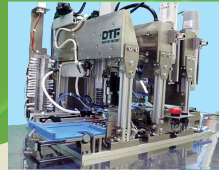
小型自动组装系统 Compact automated assembly system
